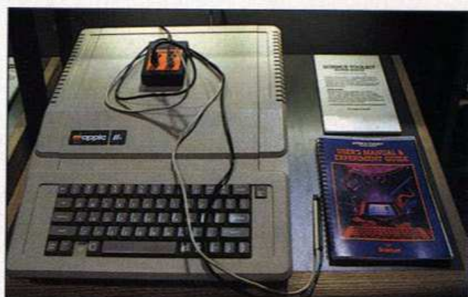
Ebenfalls bei Broderbund: Science Toolkit, ein Programm zur Meßwerterfassung mit Interface, Licht- und Temperaturfühler
